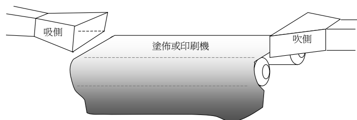
圖 5 設備運用吹吸式集氣方式示意圖
