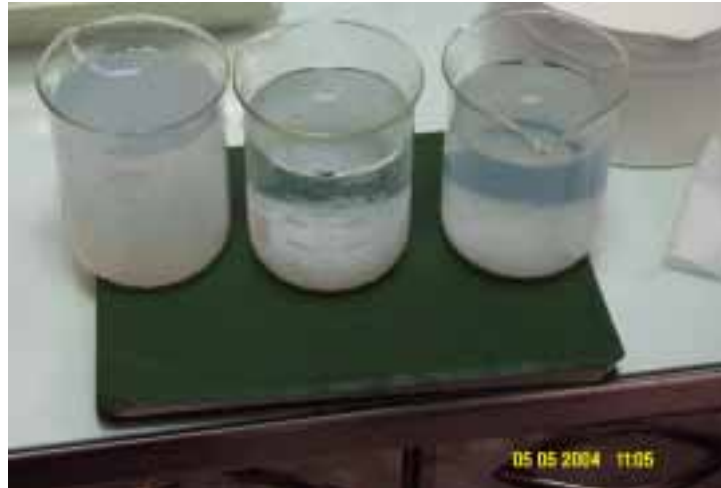
圖 4 不同 pH 下添加高分子凝集劑之結果
