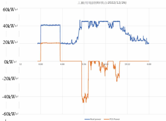
圖 7 廠區用電透過儲能系統有效抑低尖峰用電
