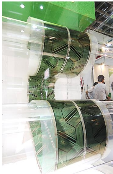
圖 8 Belectric 使用 PV2000 在 PET 軟性基板上，以捲軸製程完成之半透明性軟性光電池模組
