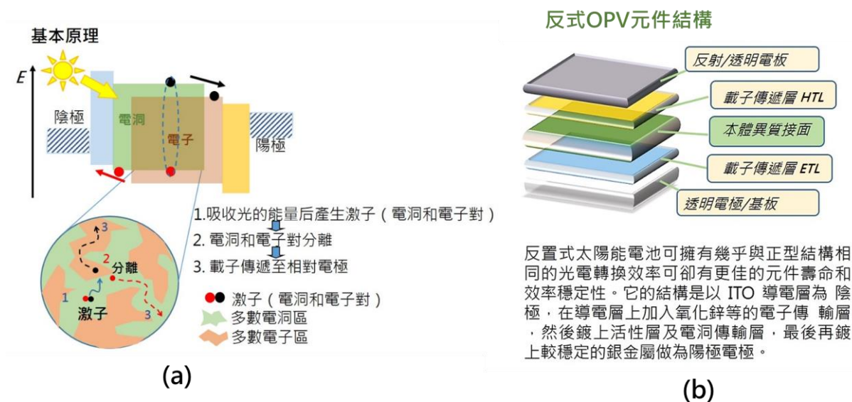
圖 1 (a)OPV 基本原理；(b)高穩定性反式 OPV 元件技術
