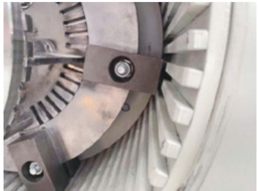
圖 5 磨粉機內部構造
