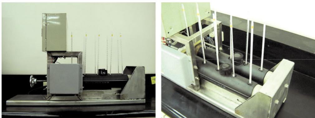
圖 6 銅奈米微粒在奈米流體熱傳導實驗之裝置設備
