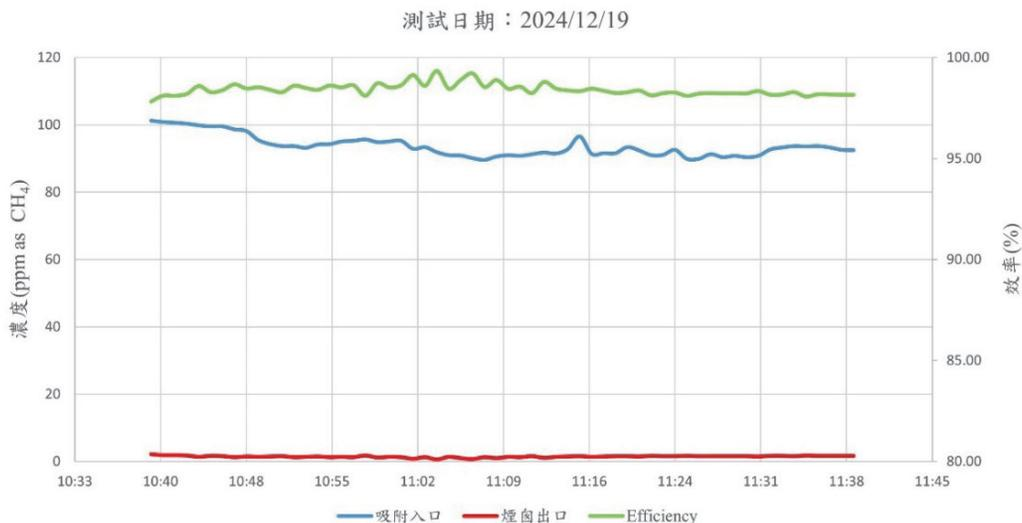
圖 7 沸石轉輪吸脫附系統結合觸媒氧化爐系統監測濃度及處理效率
