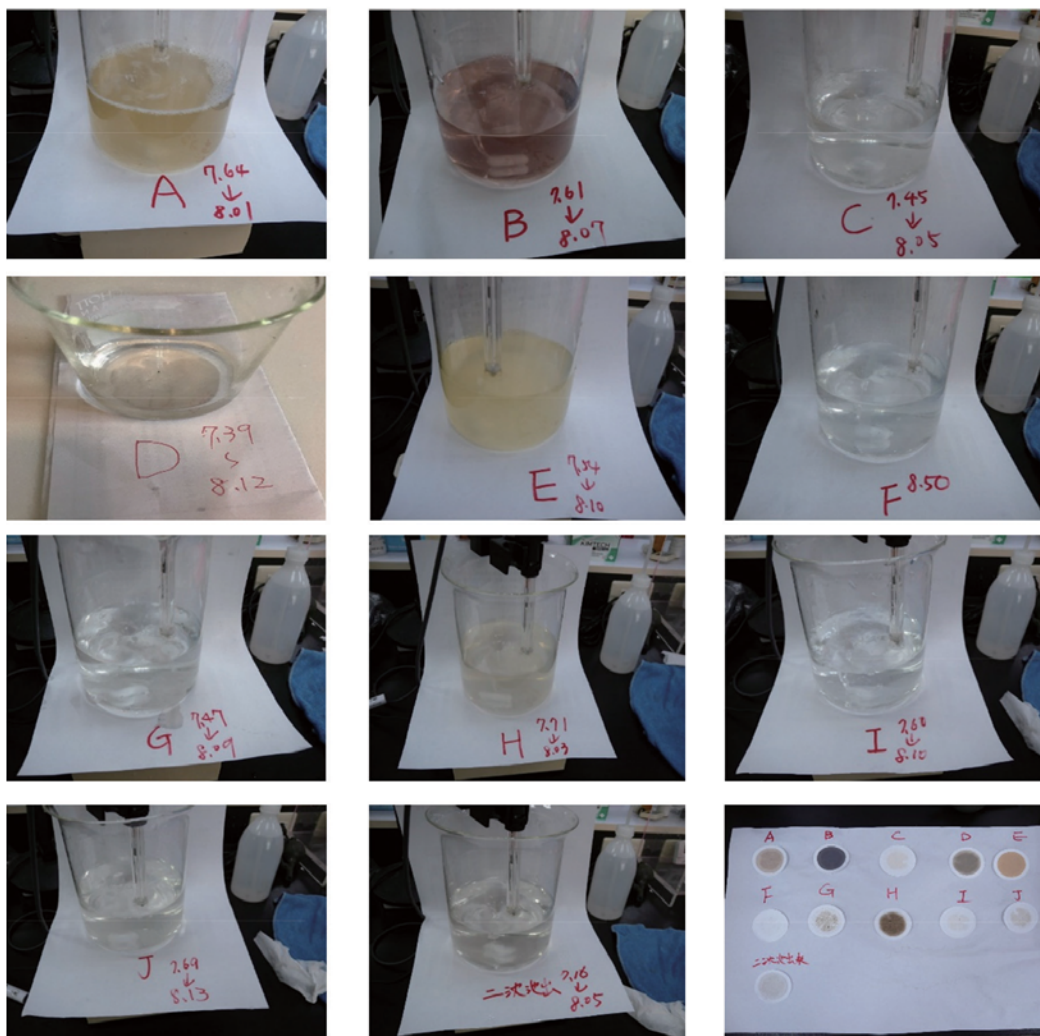
圖 11 大甲幼獅工業區下水道已改善「氟鹽」污染物用戶(納管廠商 A~J)與及本廠二沉池出水與廠內氫氧化鈉反應及過濾試驗圖
