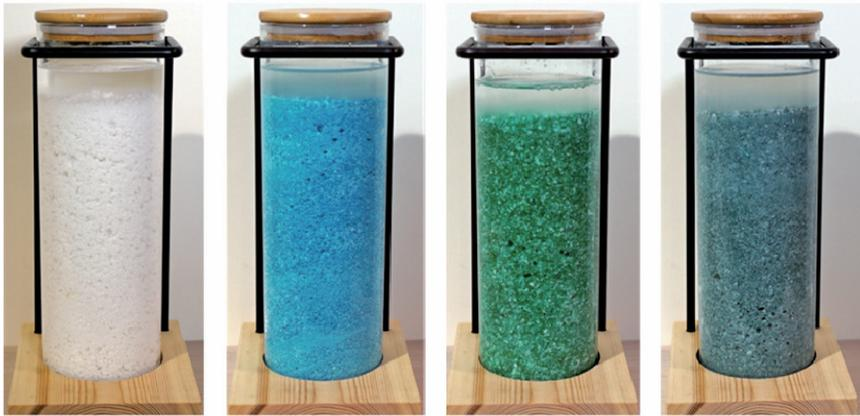
圖 5 LCD 玻璃奈米孔洞材料
