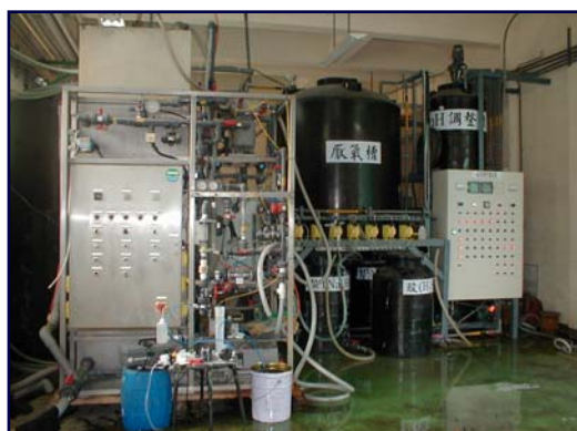
圖 1 國立交通大學於 1999 建立國內第一套 MBR/RO (0.5 m 3 /day)模型測試機
