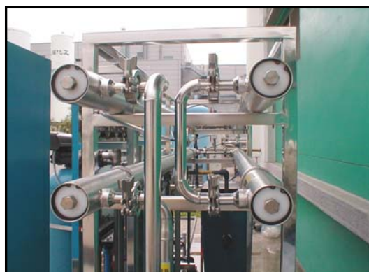
圖 1 國立交通大學於 1999 建立國內第一套 MBR/RO (0.5 m 3 /day)模型測試機
