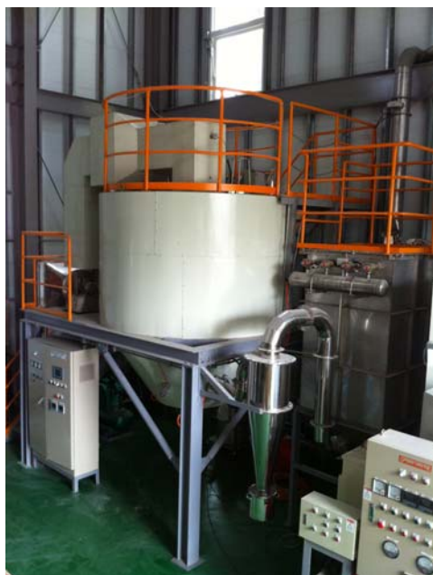
圖 13 MSP 噴霧乾燥實驗模廠(pilot scale, 1kg/hr)
