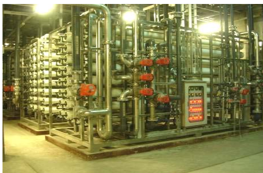
圖 6 台灣最大規模 MBR/RO/AOP 處理廠(22,500 m 3 /day, 水回收率 88%以上)
