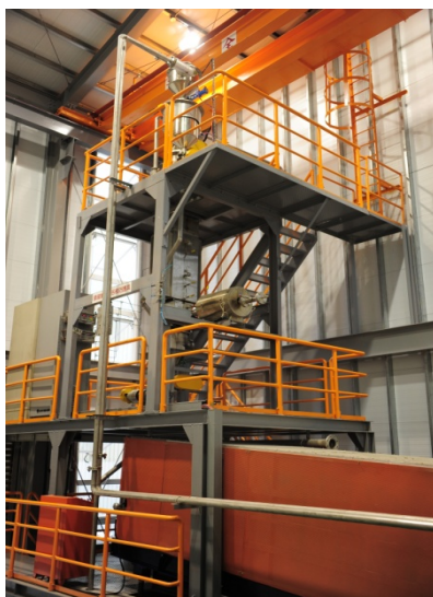
圖 9 工研院鈣循環捕獲 CO 2 實驗廠相片(3kWth)
