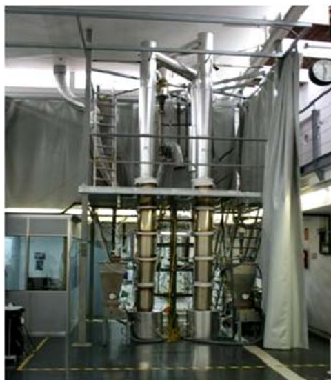
圖 2 INCAR-CSIC CaO Looping 實驗廠相片(30kW)
