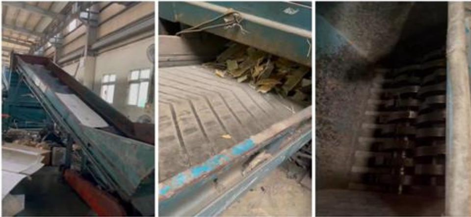
圖 5 廢風機葉片前處理需經過粗破碎及細破碎程序
