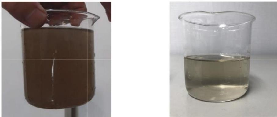
圖 5 原廢水與放流水比較(a)原廢水；(b)放流水
