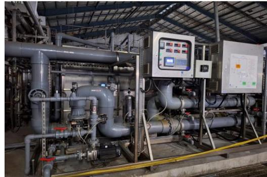
圖 4 UF 有機管式膜系統設備
