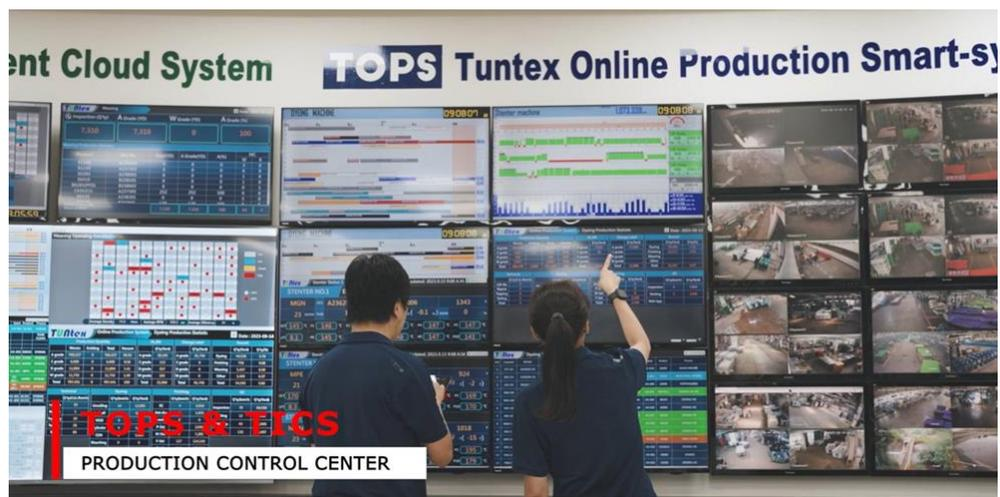
圖 3 紡織業視覺化製造設備管理系統示意圖
