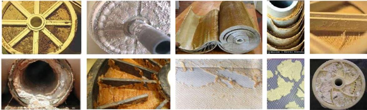
圖 6 礦物結垢堵塞的 RO 膜情況
