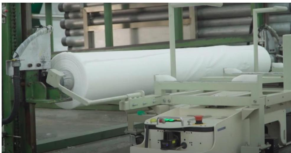
圖 4 紡織業自動化運輸系統示意圖
