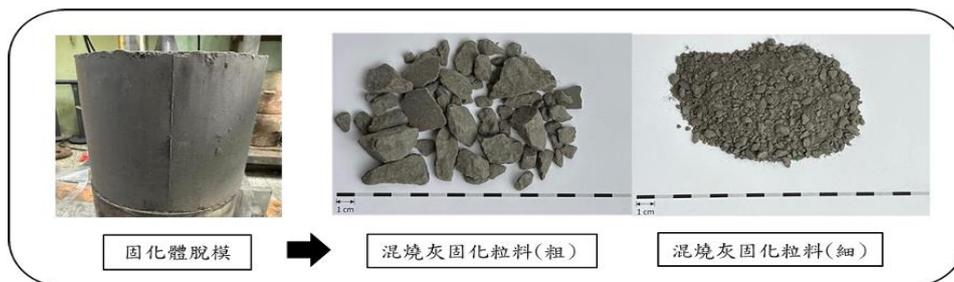
圖 9 實驗室內進行破碎材製程
