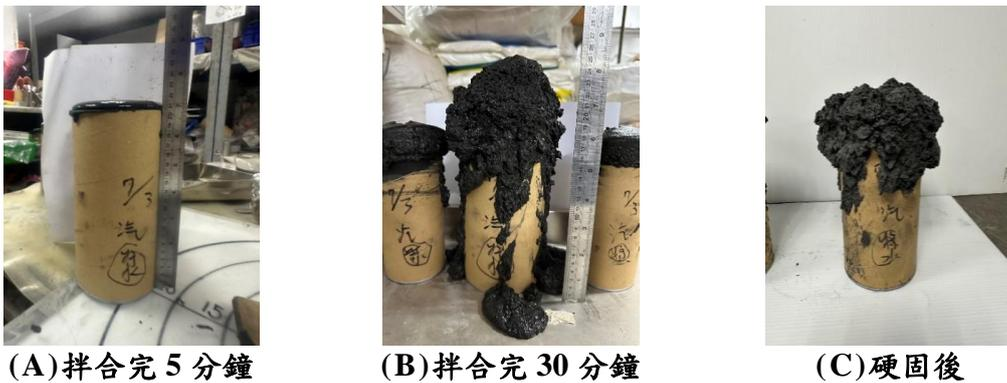
圖 10 B 廠漿料材製程體積變化歷程
