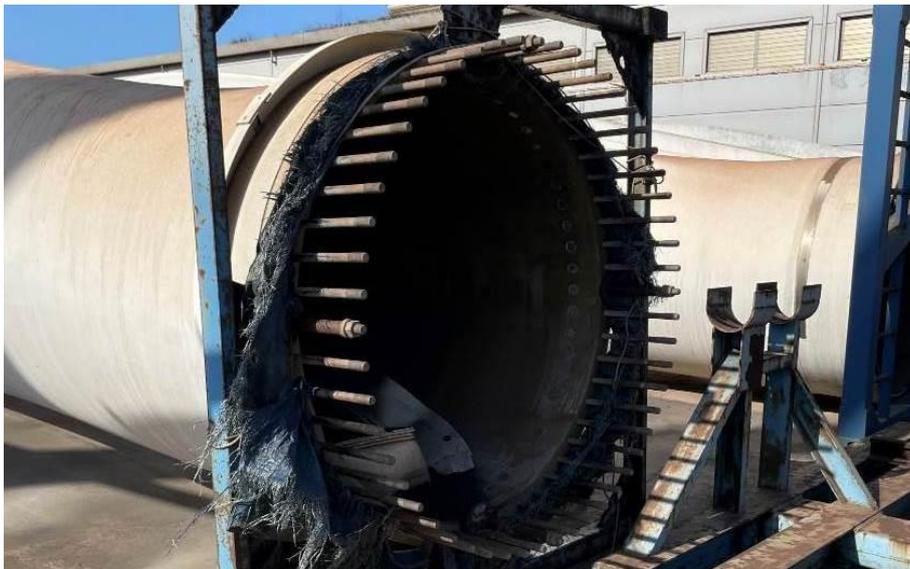
圖 3 廢風機葉片根部上有許多金屬螺栓
