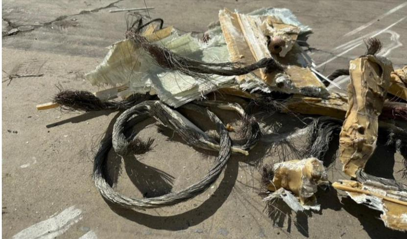
圖 4 廢風機葉片前處理挑選出來的防雷擊系統之接閃器與導線
