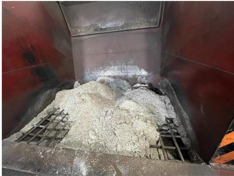
圖 8 廢風機葉片碎料在投料口加料的外觀
