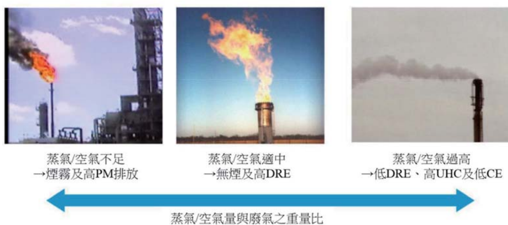
圖 1 燃燒塔使用不同的蒸氣 / 空氣量與廢氣之重量比與燃燒情形 (John Zink Company LLC, 2021)
