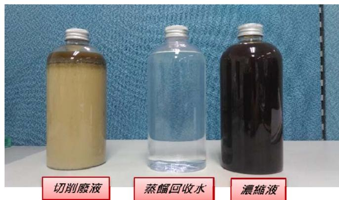
圖 7 真空蒸餾前後之廢切削液外觀狀況
