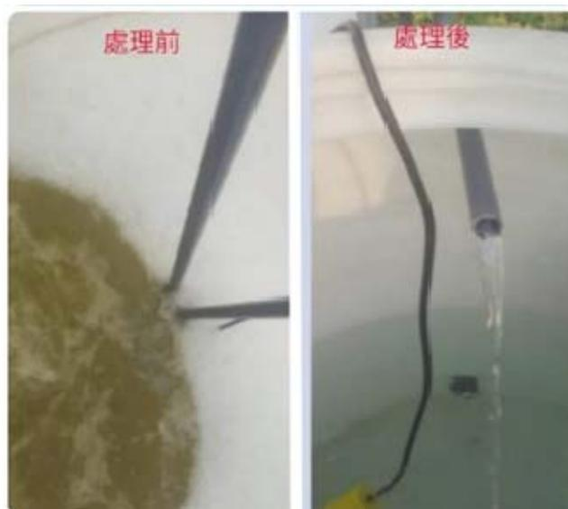
圖 7 鎳沉池放流水高級氧化-解離處理結果
