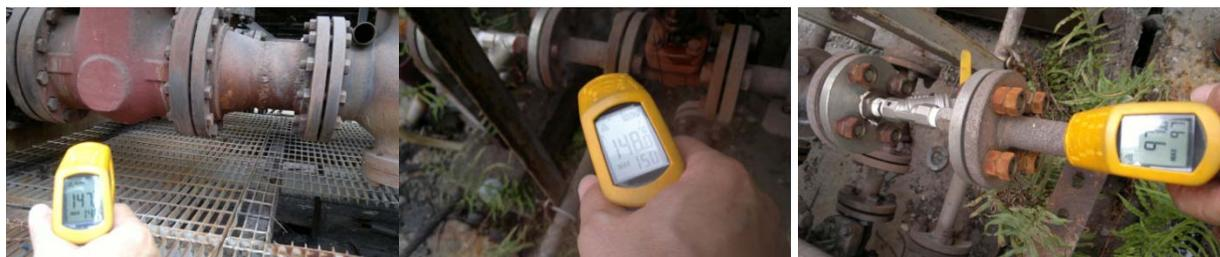
a. 蒸汽控制閥後溫度 147°C      b. 節汽系統入口溫度 148°C      c. 節汽系統出口溫度 97°C
