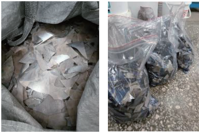
圖 21 裂解後回收玻璃(原先為一整片便於放置而敲碎)及電池
