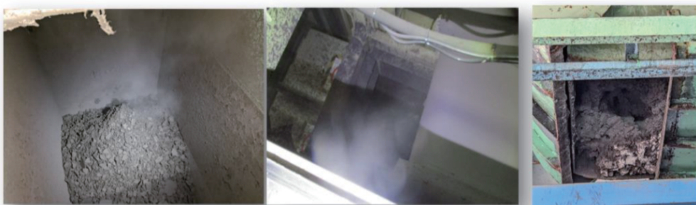
圖 6 無機污泥斗冒煙和污泥卡住狀況
