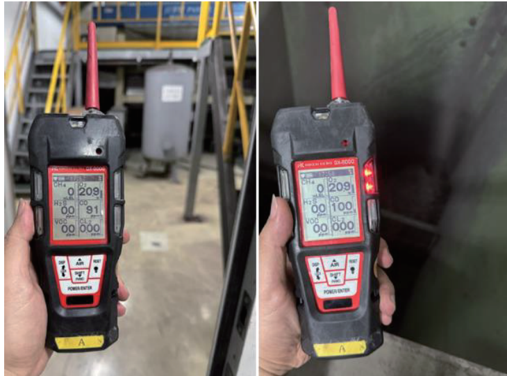
圖 11 攜帶式偵測器 CO 讀值偏高
