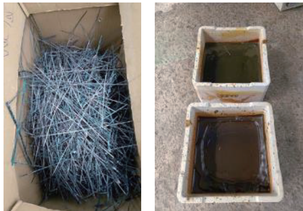
圖 22 裂解後回收有價導線緞帶及熱裂解收集裂解油
