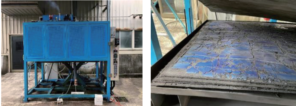
圖 20 電漿熱裂解太陽光電模組及光電模組裂解後材料分層
