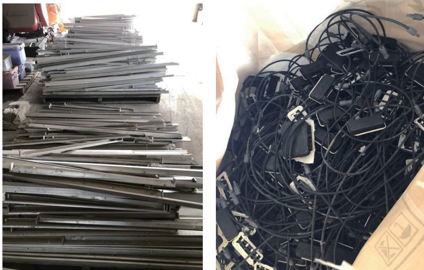
圖 18 拆除鋁框和接線盒背板
